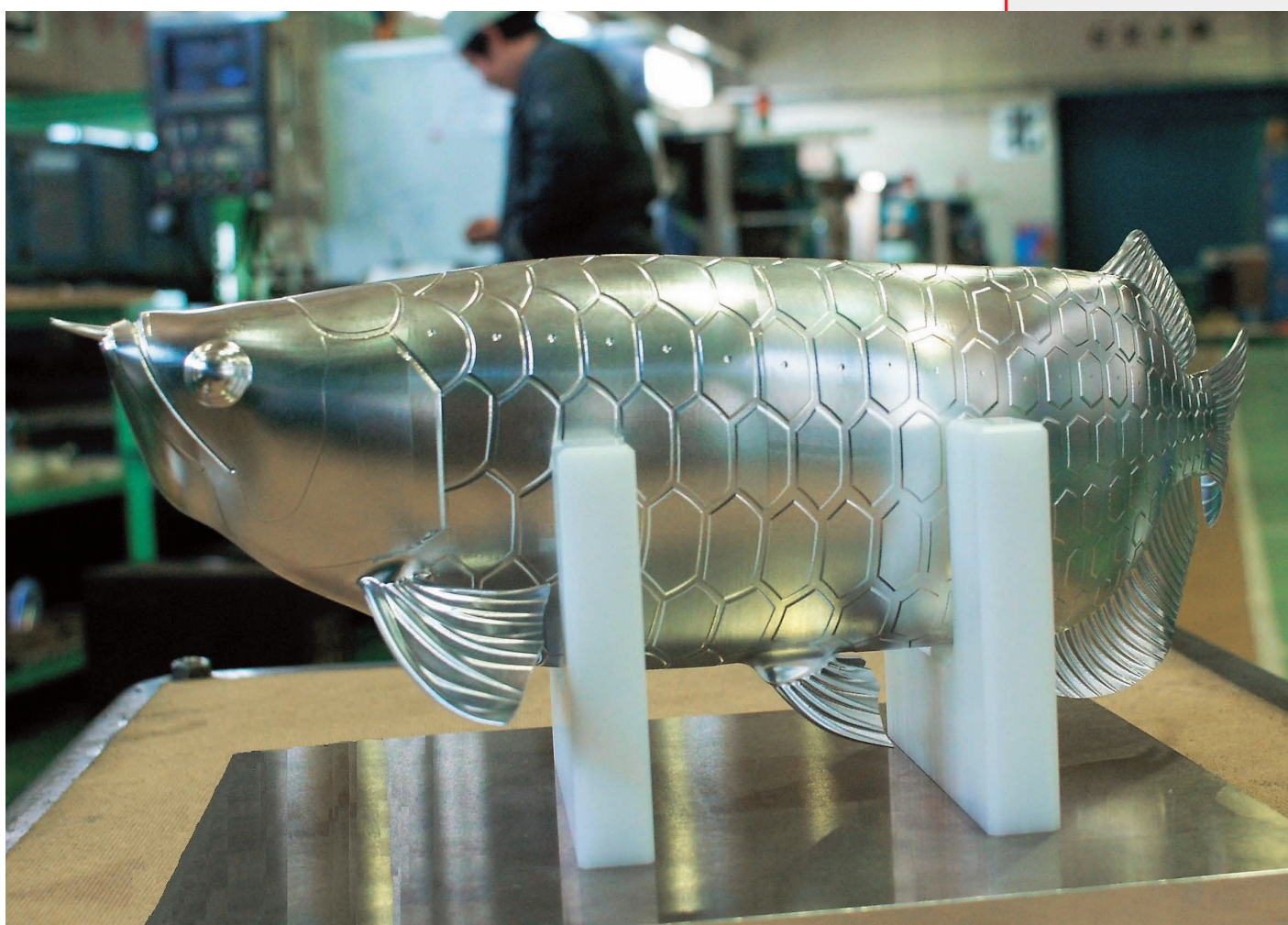
切削加工のみで製作したアロワナ(有限会社今橋製作所)
